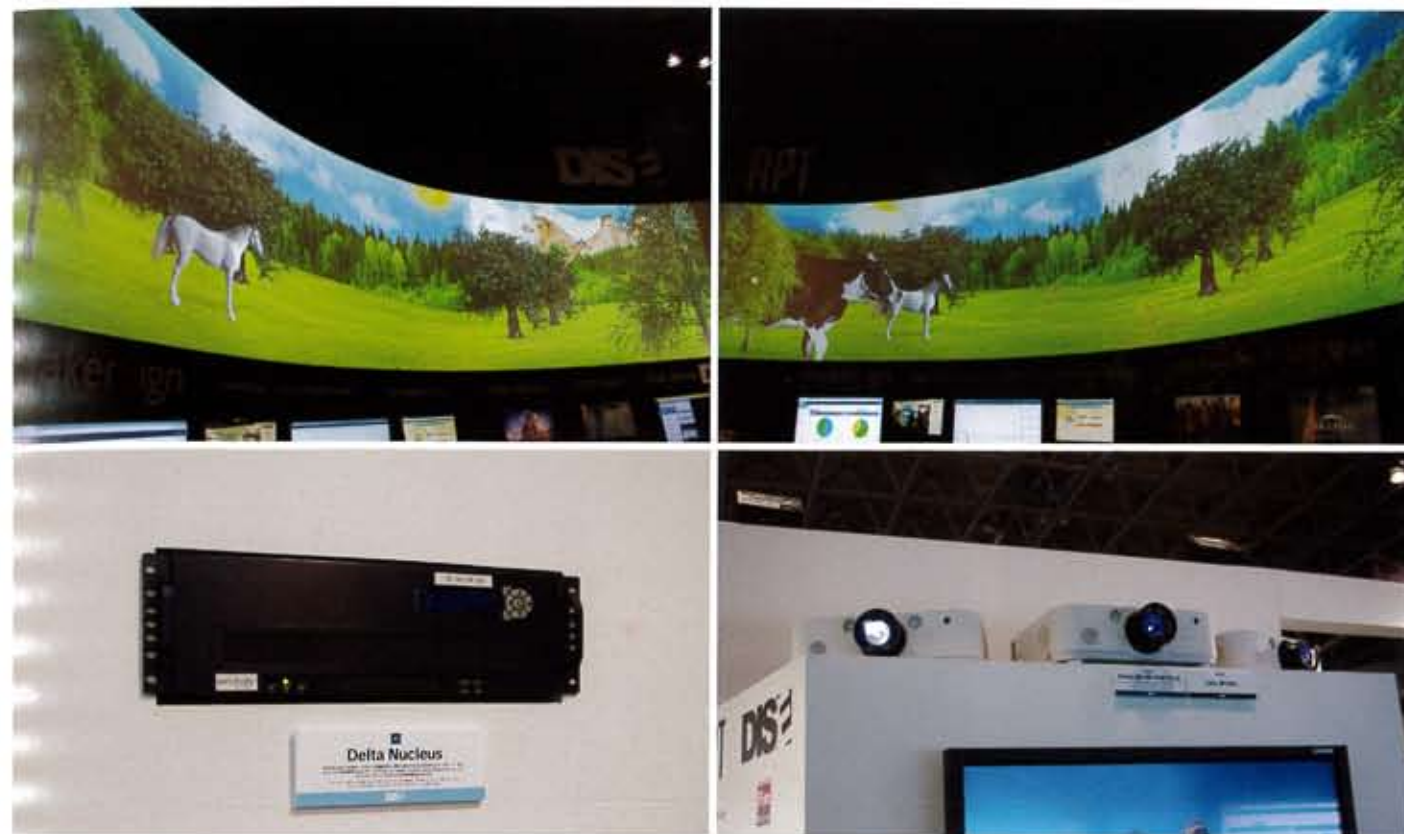
▲ ブース内に設置された「Dome Projection」では、NEC社のプロジェクター「ViewLight NP-PA621UJL」(右下)を3台使用。メディアサーバーは7thSense Design社の「Delta Nucleus」(左下)を採用している。なお、スクリーンには、プロジェクション専用開発された、反射効率の高いアクリル成分のコーティング「screen goo」が塗布されており、投影されたコンテンツの明るさはプロジェクター本来のスペックを超えるものとなっている。
