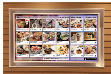
▲ レストランフロアに設置された飲食店舗一覧。WEBサイトの店舗発信情報を連携表示するなど、来店きっかけを創出する機能としても活用している。70インチの液晶ディスプレイ(解像度FHD、輝度700cd/m 2 )1面。
