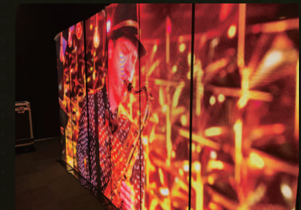
▲至近距離からの視認を可能とする自立型高精細LEDビジョン(W0.6×H2m 6面連結、W3.5×H2m 2.5mmピッチ・1,200cd/m 2 )。
